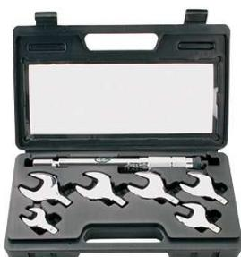
Coffret clé dynamométrique réglable
