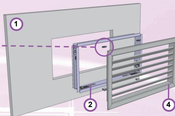
Clips de fixation à friction, pour le montage et le démontage rapide de la grille, la forme spécifique permet le maintien dans le crénelage du contre cadre ou le bourrelet des plénums. (montage en plafond déconseillé).
